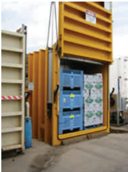
Figura 23 - Câmara de arrefecimento por vácuo.
