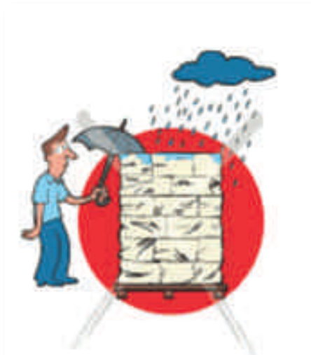
Figura 86 - Descarga protegida de intempéries.
