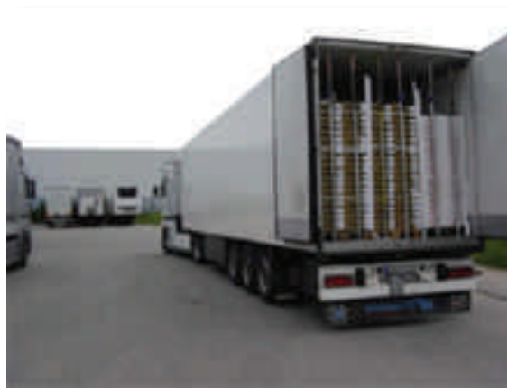
Figura 9 - Camião de transporte de frutas e legumes com caixa isotérmica, mantém temperaturas baixas constantes.
